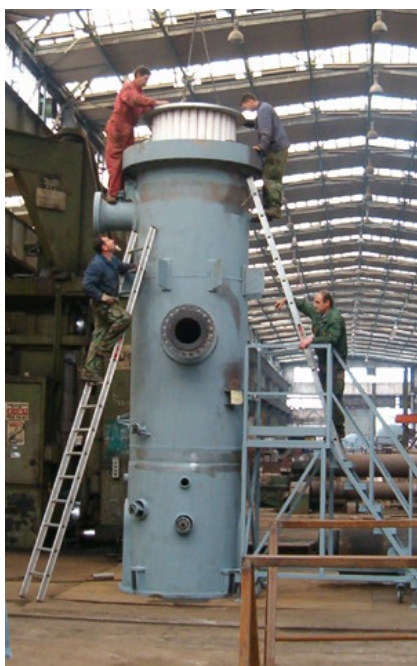
9. sz. ábra Ciklonszeparátorunk 210 bar 5 millió m 3 /nap
